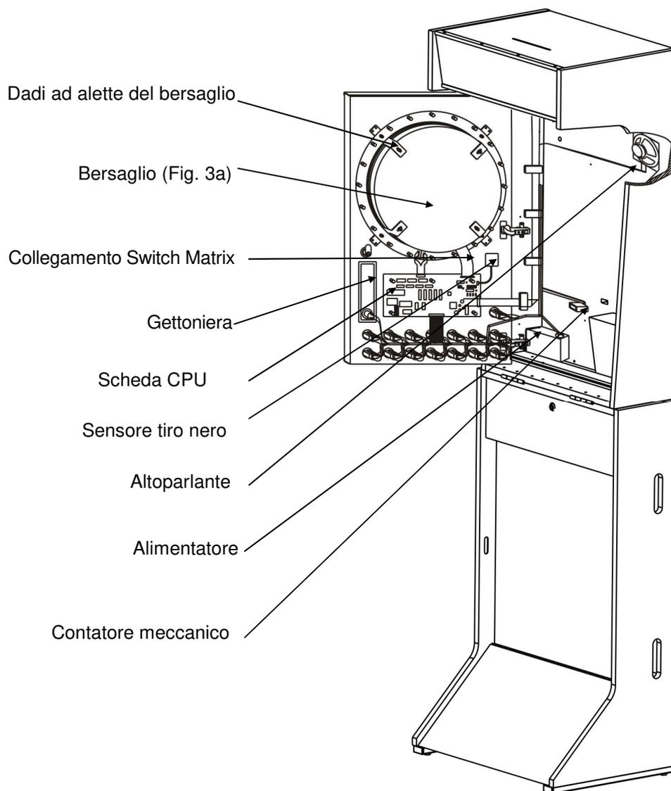
Fig. 3 mostra la parte interna del dispositivo. Le unità elettriche sono modulari e possono essere facilmente sostituite.
